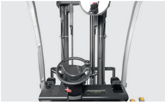
Una buona visibilità attraverso il montante garantisce maggiore sicurezza oltre all'incremento della produttività*
