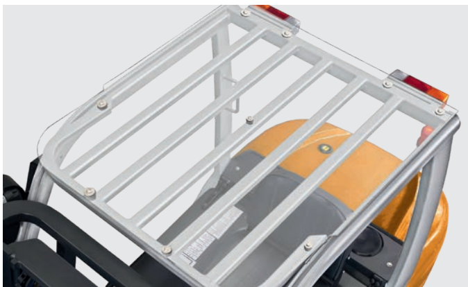
Barre sottili sul tettuccio di protezione assicurano una visibilità ottimale e la massima sicurezza
