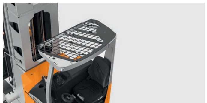
Qualunque sia l'applicazione, offriamo il tettuccio di protezione più adatto, ottimizzato in termini di visibilità, con o senza copertura in metallo o policarbonato
