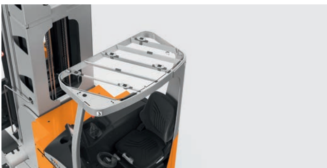
Qualunque sia l'applicazione, offriamo il tettuccio di protezione più adatto, ottimizzato in termini di visibilità, con o senza copertura in metallo o policarbonato
