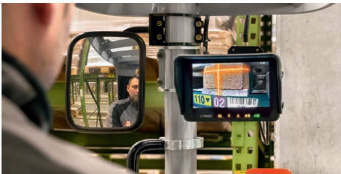
Sistema di telecamere opzionale per una visibilità ottimale durante le operazioni di carico e scarico
