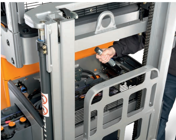
La sostituzione della batteria laterale di serie assicura la massima disponibilità del carrello
