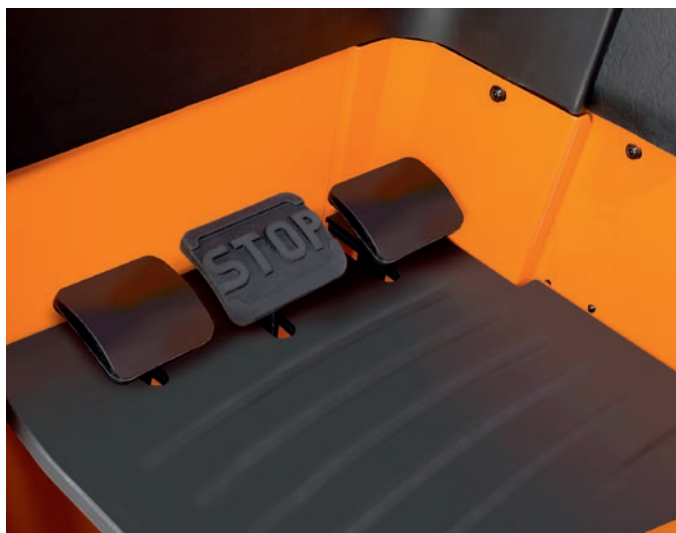
Precisione fino al livello più basso con i pedali per cambio di direzione rapido
