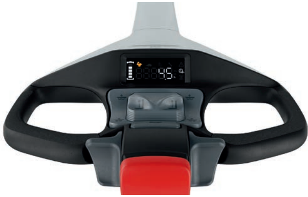
Tutte le informazioni sono immediatamente visibili sul display a LED integrato nella testa del timone
