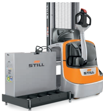
Massima disponibilità del carrello EXV 14 C grazie al cambio laterale della batteria (opzionale)
