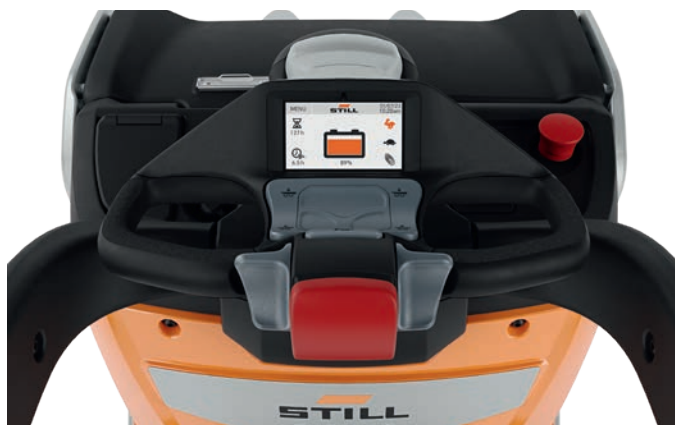
Tutto sempre sott'occhio: il display LED o touch presenta in modo chiaro tutte le principali informazioni sul carrello
