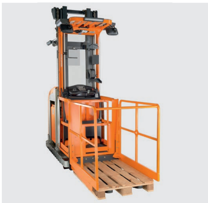
Versione pallet walk-on con gabbia opzionale per un picking ergonomico di merci pesanti e voluminose
