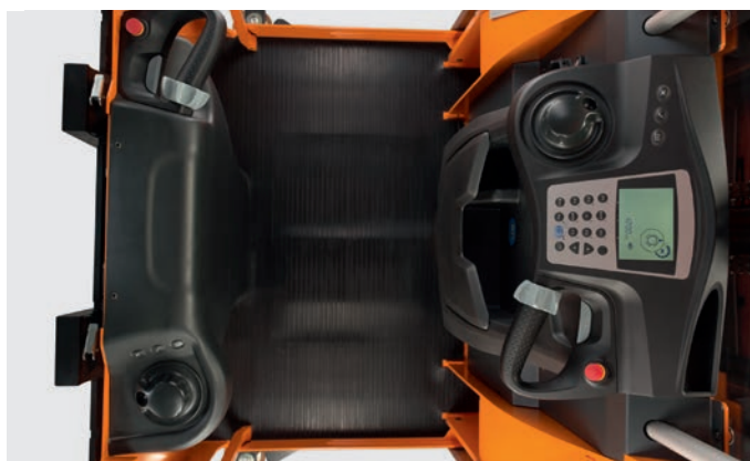
Utilizzo efficiente del carrello elevatore grazie al funzionamento su due lati opzionale
