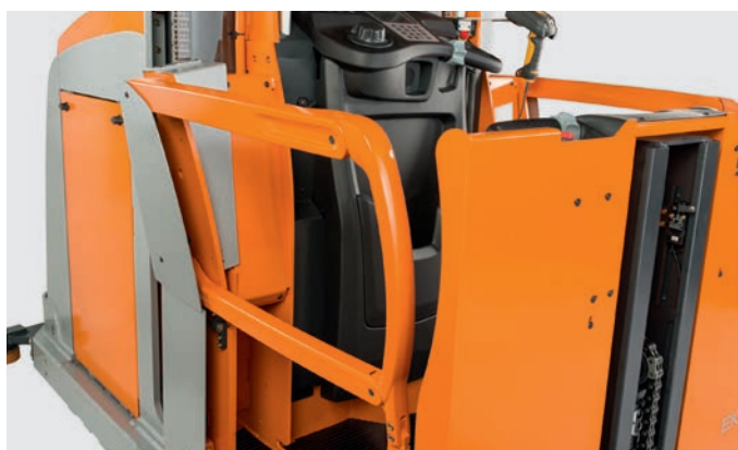
Cancelletti reclinabili per un picking ergonomico fino all'ultimo articolo del pallet
