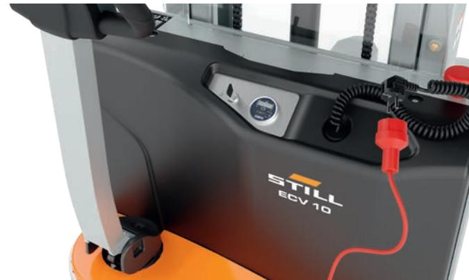
Il caricabatteria integrato garantisce la massima disponibilità e consente la carica decentralizzata, con chiara indicazione su display LED dello stato della batteria e delle ore di funzionamento
